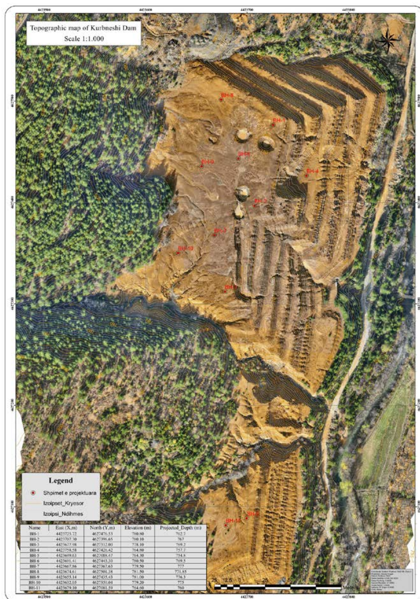
Aneksi 1. Harta topografike e Dambës së Kurbneshit, me pozicionimin e 11 pikave të shpimit (BH-1 – BH-11).
